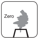
Zero Halogen IEC 60754-1/NF C20-454 EN 50267-2-1
